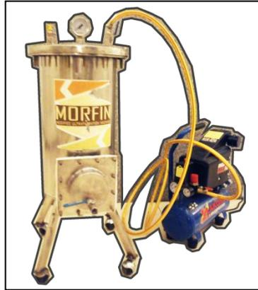
Gambar 3. Hasil Rancangan MORFIN (*Modified Ultrafiltration Machine*)
