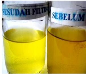
Gambar 5. Penampakan Sari Buah Belimbing Sesudah dan Sebelum dilakukan Ultrafiltrasi
